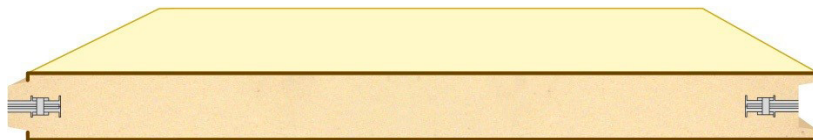
Laminado PRFV liso sin gelcoat
