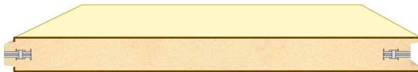
Laminado PRFV liso con gelcoat
