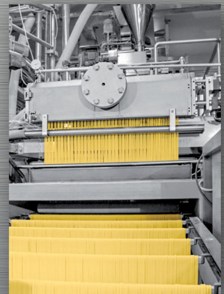
Particolare della testata per estrusione con tagliapasta
