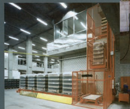
Elevatore pallets Pallets elevator
