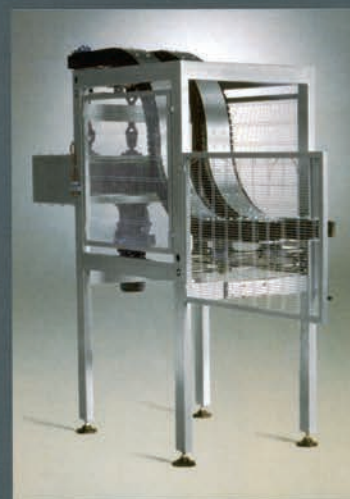
Elevatore autoregolante Self-adjustable elevator
