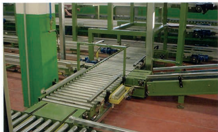
Deviatore per pallets 90° deviators for pallets
